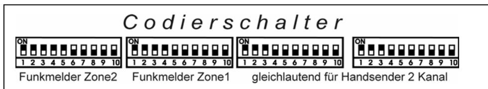
während der erste (Zone2) & zweite (Zone1) Schalter eine jeweils abweichende Einstellung, nämlich wie der Funkmelder pro Zone aufweisen muss. Die 2–fach Codierschalter dürfen bei normaler Verwendung nicht verstellt werden!
